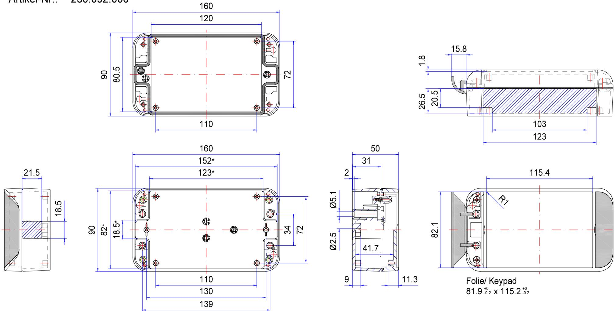
\* Bitte beachten: Gehäusewand mit Entformungsschräge, Maßangaben in Höhe des Gehäusebodens!
