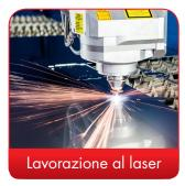
Grazie al nostro centro di taglio laser interno, siamo in grado di trattare custodie e piastre in acciaio inossidabile in modo rapido e affidabile in base ai vostri requisiti specifici.
